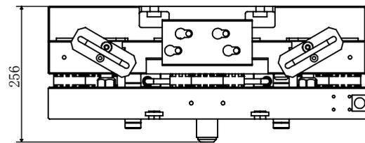
硅橡胶注射冷流道系统：三板式硅橡胶注射冷流道系统，包括：上冷流板、下冷流板、模具上电热板、分体式整体流道、注胶柱、多个分散型隔热块、多个液体循环冷却式注胶嘴、多个冷却液出入口和快速锁模导轨，所述下冷流板固定安装在所述上冷流板的底部，所述注胶柱固定安装在所述上冷流板内，所述分体式整体流道设置在所述上冷流板和下冷流板之间，所述注胶柱与所述分体式整体流道相连通，所述模具上电热板设置在所述下冷流板的下方，多个所述分散型隔热块均固定安装在所述模具上电热板的顶部。本发明提供的三板式硅橡胶注射冷流道系统具有分料均匀、不易发生死料的优点。
